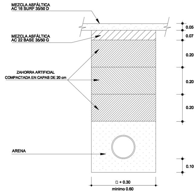
DETALLE DE ZANJA REPARACIÓN SUMIDERO Y TRAMO COLECTOR
