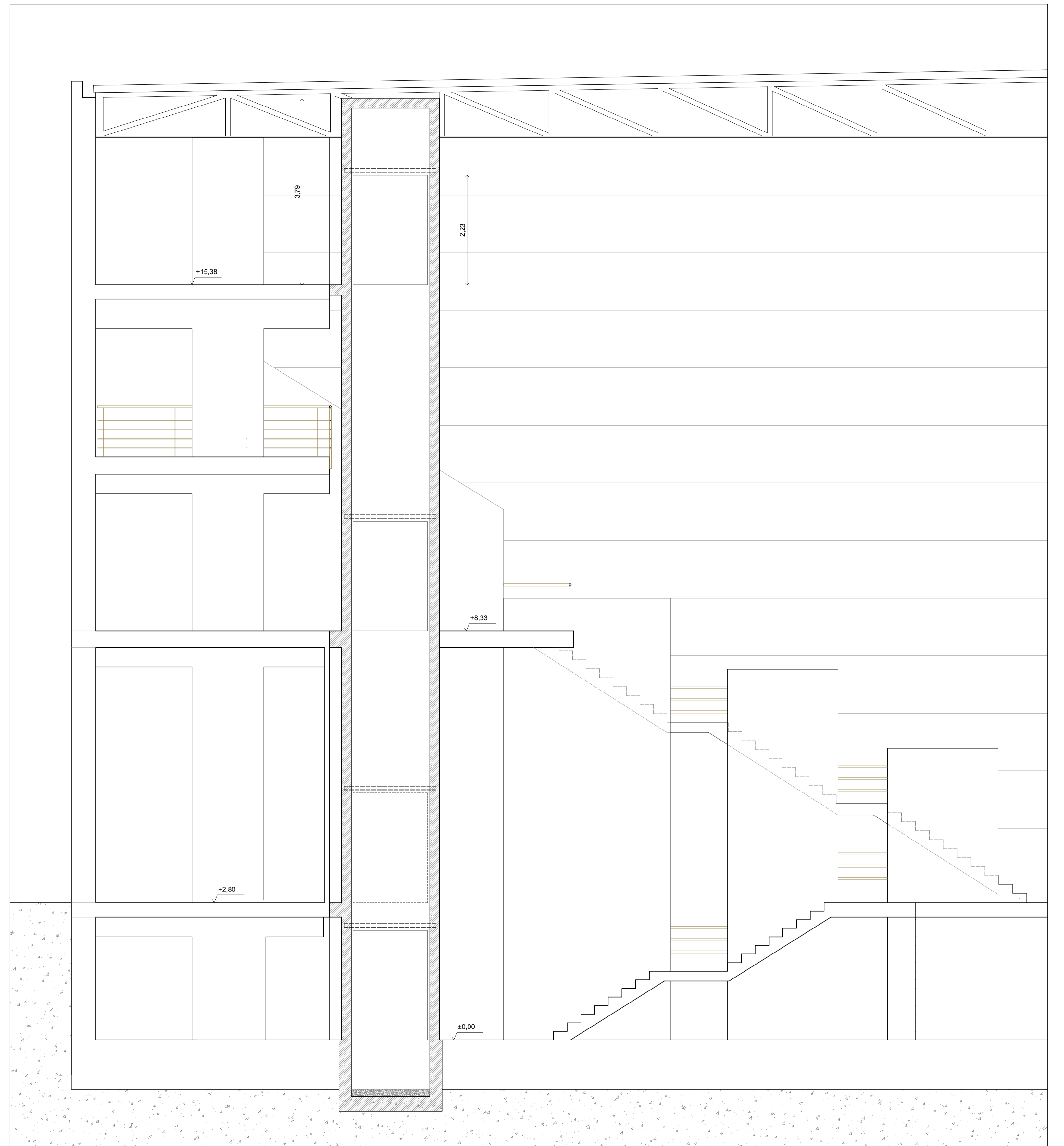
SECCIÓN B-B: ESTADO REFORMADO. ÁMBITO ASCENSOR 2. ESCALA 1/50
