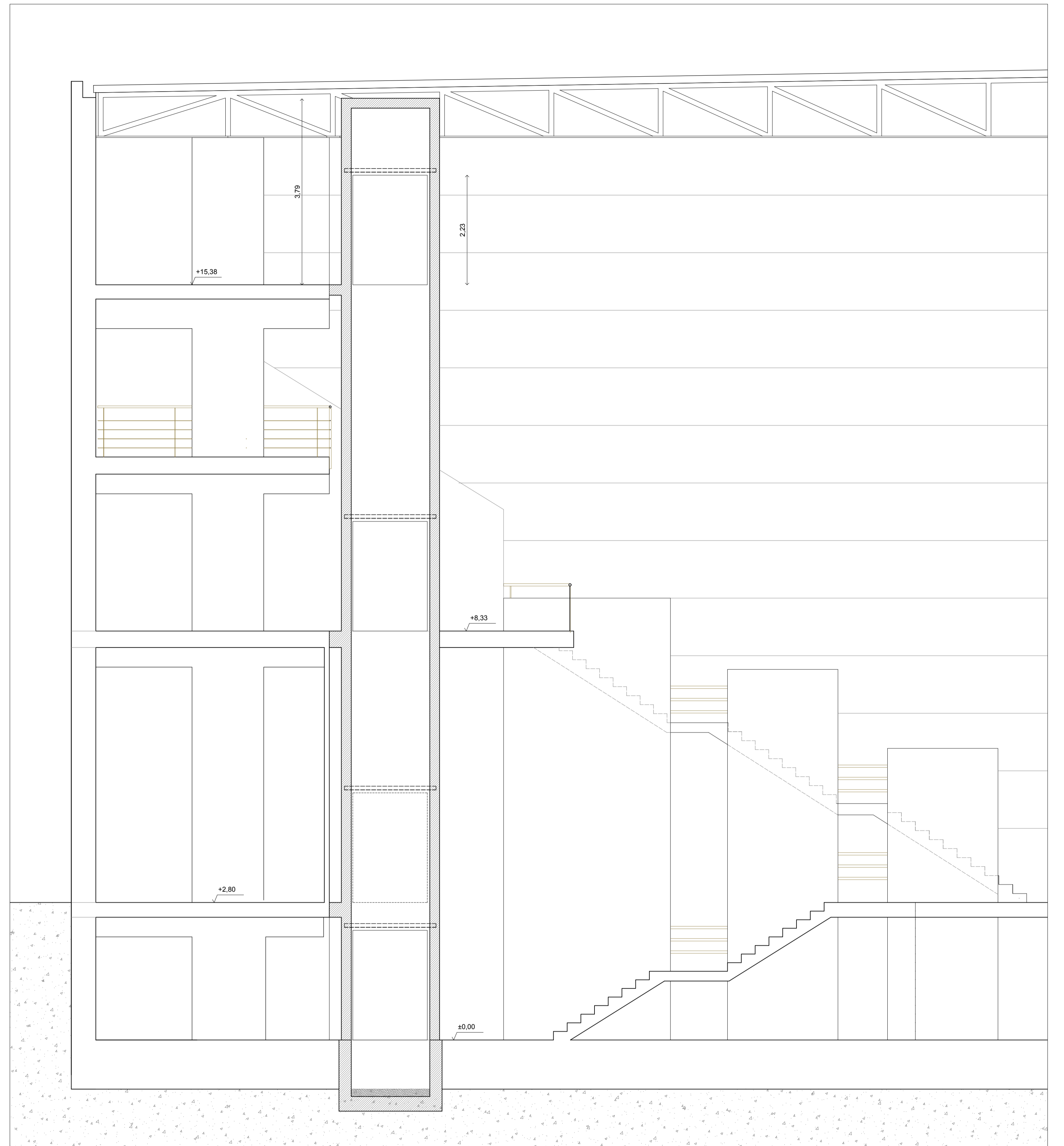
SECCIÓN B-B: ESTADO REFORMADO. ÁMBITO ASCENSOR 2. ESCALA 1/50
