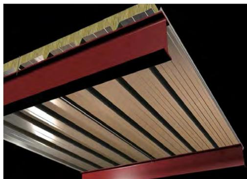
Hay que prestar atención a los encuentros con elementos peculiares, como los bordes, esquinas y canalones, donde el grueso del aislamiento quedará bien protegido del agua. Así se garantiza la estanqueidad de la cubierta frente a los agentes atmosféricos, y se mejora el confort dentro del edificio.
