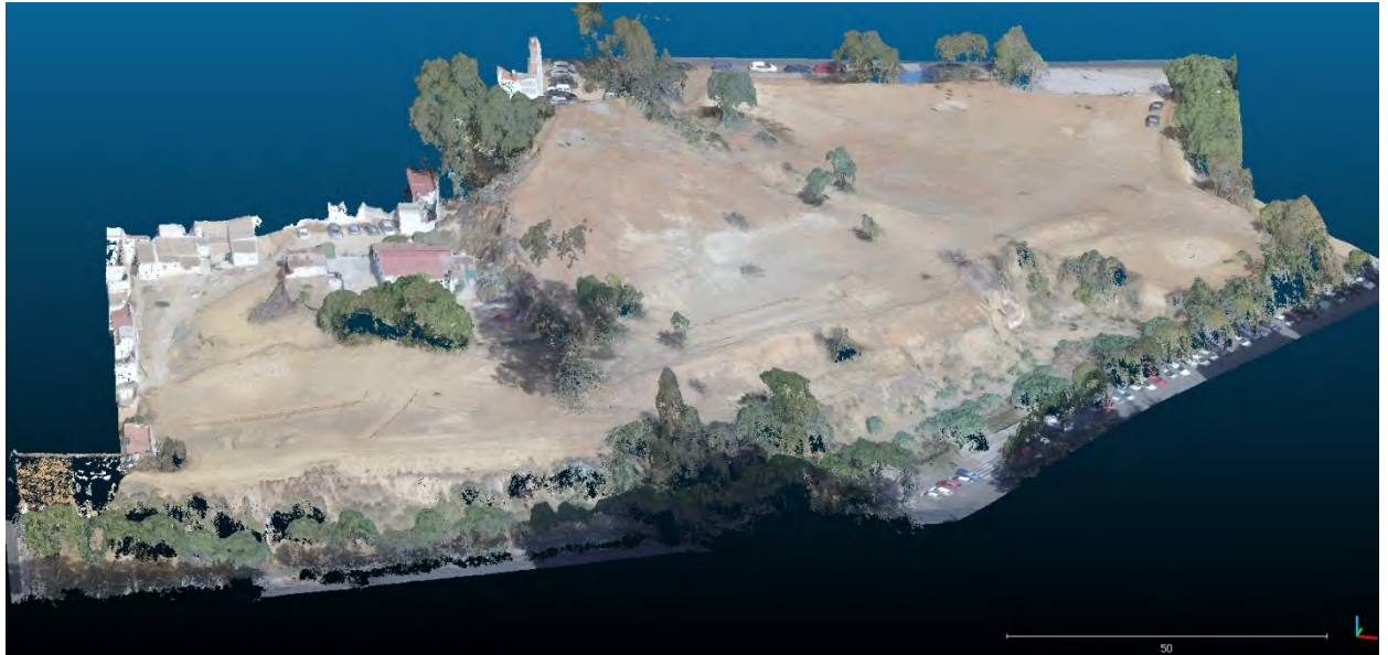
Ilustración 6: Nube de puntos procedente de la restitución fotogramétrica.
