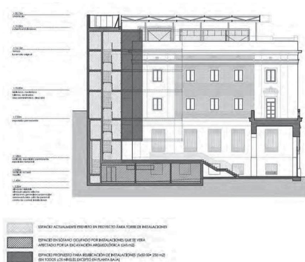
Fig. 11.- Sección transversal por el patio identificando el nuevo espacio propuesto para reubicación de instalaciones.
