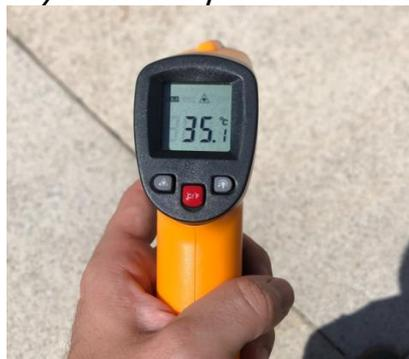
*\* Como puede apreciarse, tanto los suelos de caucho como de césped artificial tienen el doble de temperatura que la ambiental marcada en 28 grados, aspecto que se contrapone al suelo de pavimento bajo sombra de arbolado o césped natural, donde la temperatura aparece mucho más regulada y se acerca al valor de la ambiental. Todo ello se eleva mucho más en días en los que la temperatura marca 35 o 36 grados, algo habitual en el verano onubense.*
