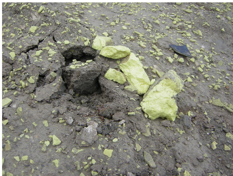
Reacción química con azufre de neoformación en el CRI 9 de la Zona 4 sobre la ilmenita inatacada procedente de la empresa TIOXIDE y depositada sobre los fosfoyesos en una “pretendida restauración”.
