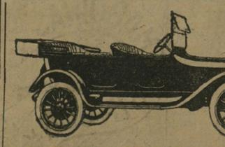
Con motor de 4 cilindros de 98 por 1 m/14 m arranque automático, alumbrado eléctrico magneto y llantas para neumático europeos.
